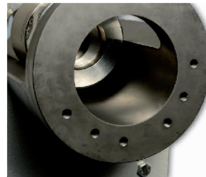
La termoregolazione con olio diatermico o acqua pressurizzata, permette di mantenere la temperatura del contenitore attorno ai 200°C riducendo i problemi derivanti da shock termico, ovalizzazione e distorsione.
